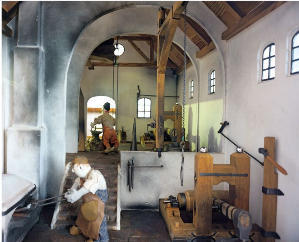
Obere Hammerschmiede am Hammerbach, Innenansicht des beweglichen Modells
